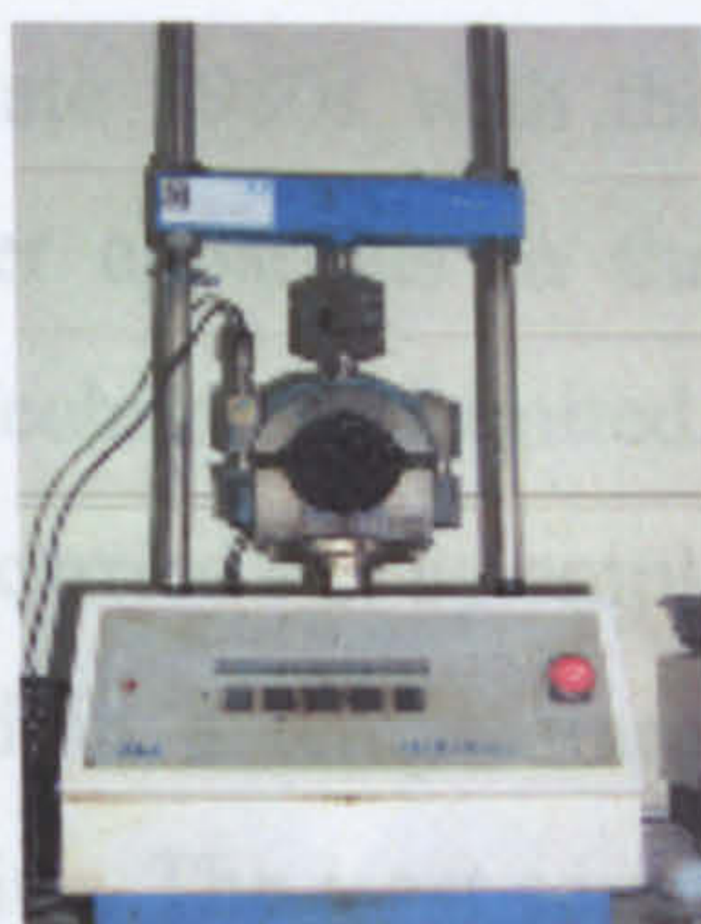
Fig. 3.4 - The Marshall test apparatus
