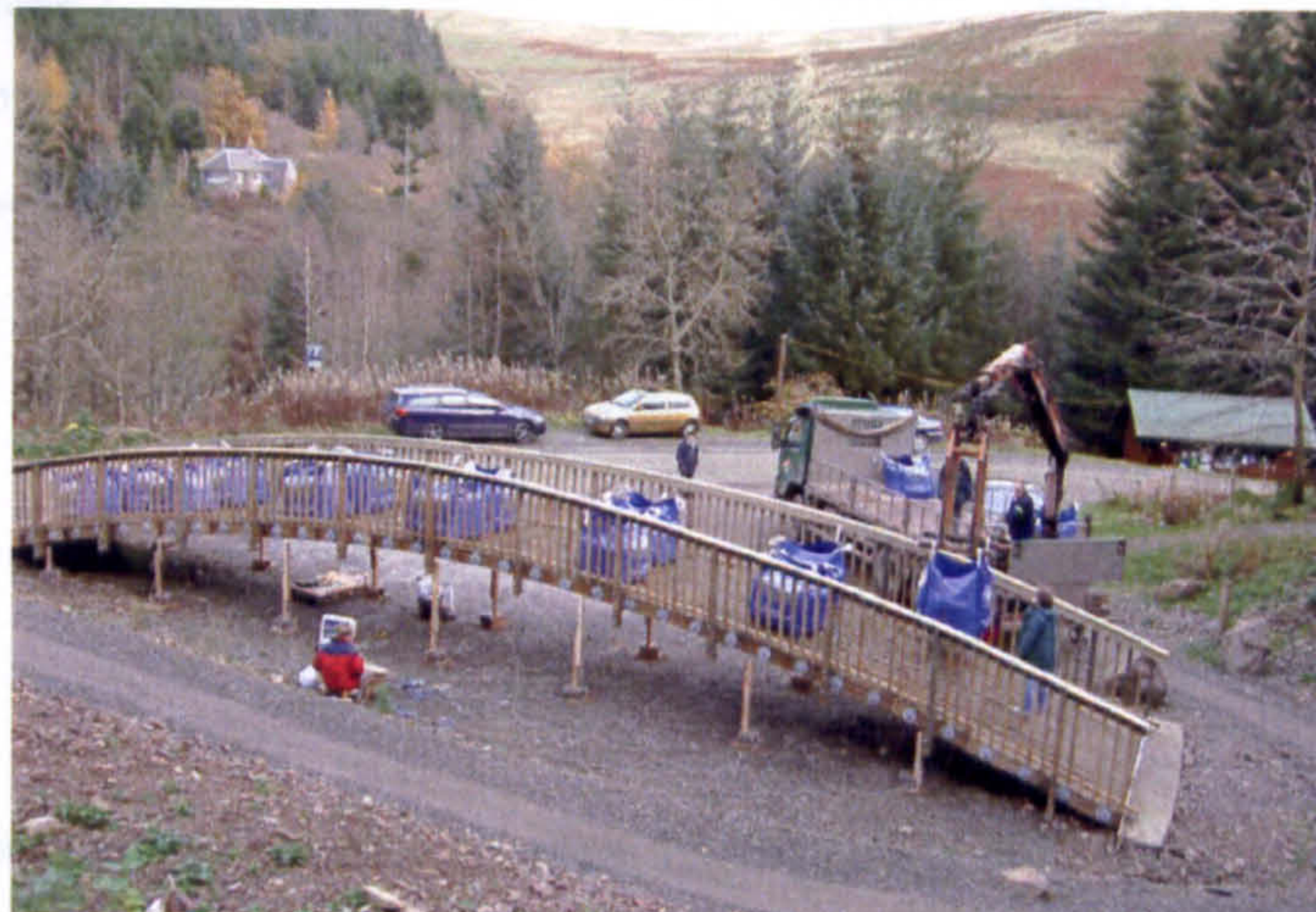
Fig 6.44(a) – 20m span UDL loading
