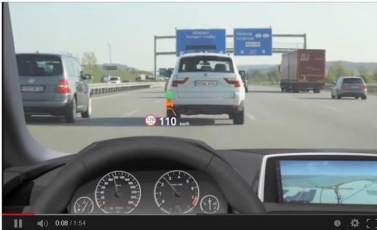
BMW: Vollfarbiges Head Up Display in Aktion
